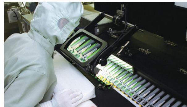
製品検査(インライン検査) Product inspection (in-line inspection)
