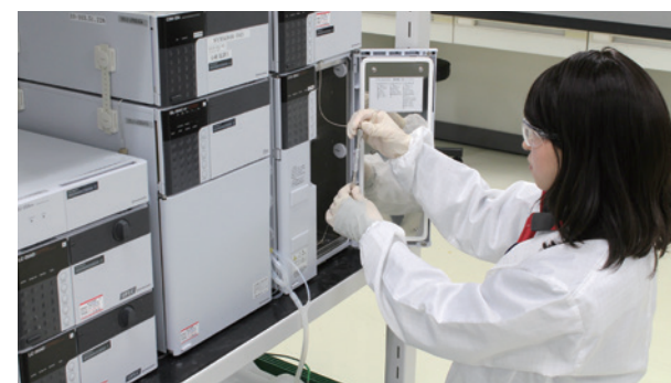
液体クロマトグラフによる理化学試験 Physicochemical tests using liquid chromatographs
