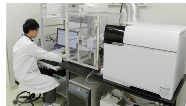
ICP-MSによる微量元素分析 ICP-MS Trace Element Analysis
